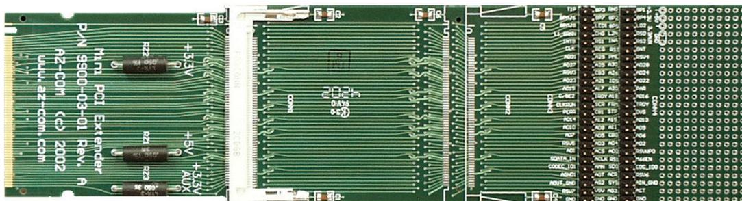
8. MINI PCI 変換アダプタ
